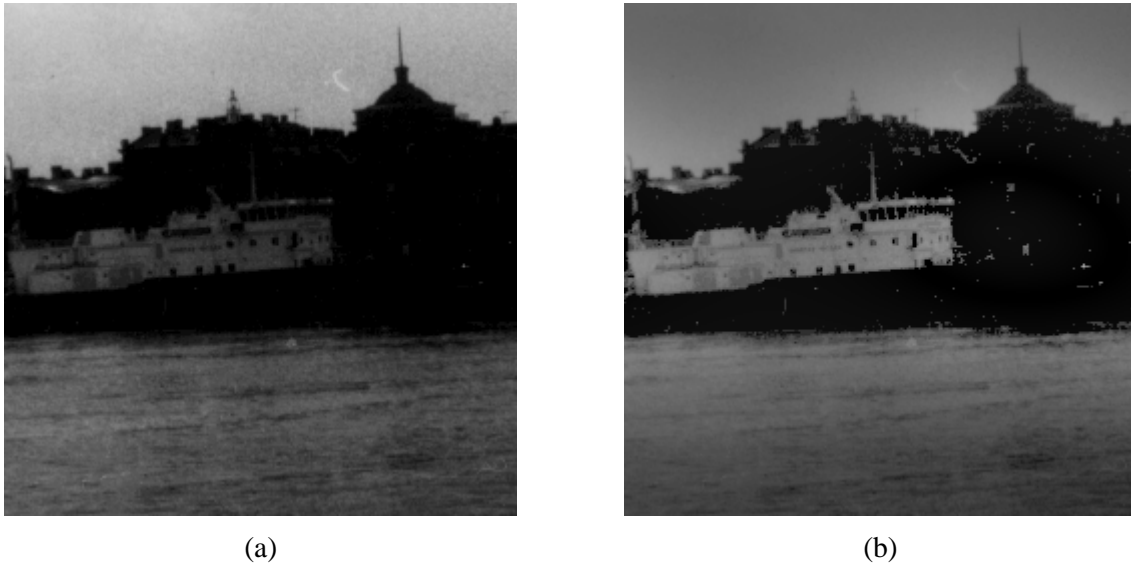
Obr. 3.9 Príklad homomorfného spracovania pre zlepšenie obrazu: a) originál 256x256 obrazových bodov, b) obraz po homomorfnjej filtrácii.
