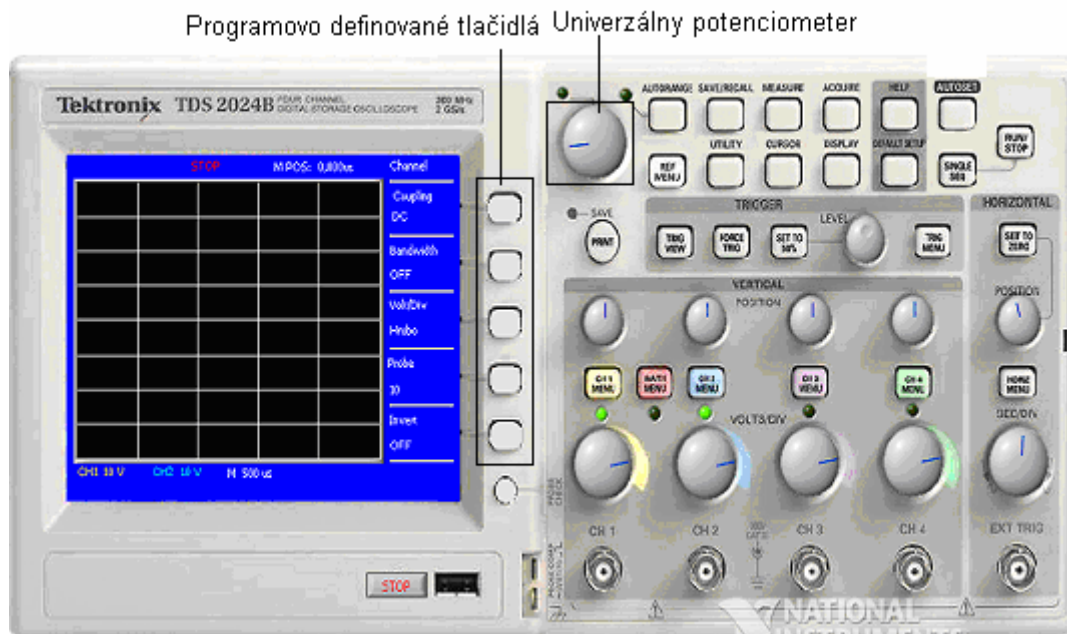
Obr. 16 Predný panel riadiaceho VI k osciloskopu TDS 2024B
