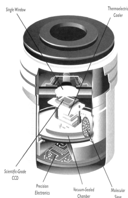
Princip infrakamery s maticí FPA
