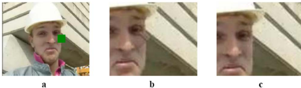
Obr. 5.8 Obnova poškodeného makrobloku v snímke a, použitím smerovej interpolácie s presným prerozdelením makrobloku na b, 4 časti c, 8 častí
